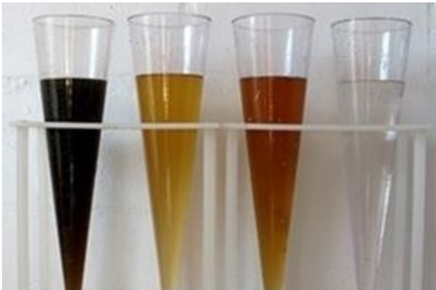
Figura 25: Tratamento do Chorume De Chorume à Água Residual Tratada
