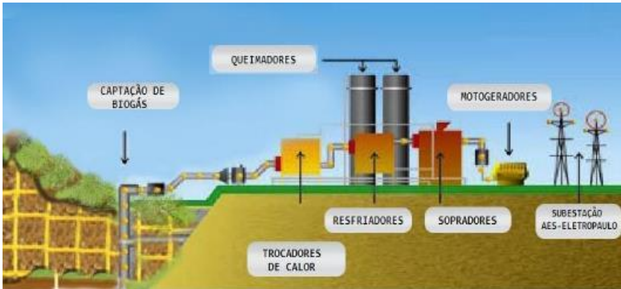
Figura 63: Fluxograma de Geração de Energia em Aterro Sanitário
