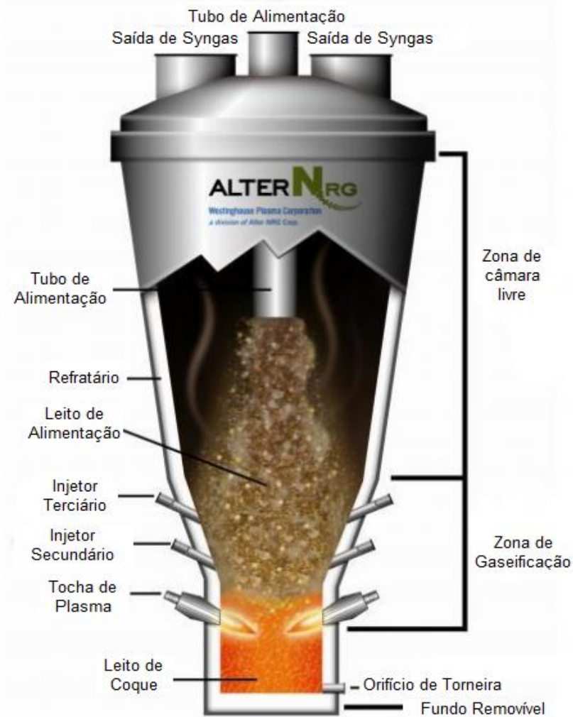
Figura 65: Reator do Processo de Tratamento de RSU por Tocha de Plasma
